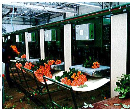
*Maschinelle Sortierung nach Länge*
